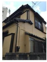
屋根は瓦を抑える漆喰を詰め直し、外壁塗装浴室、玄関タイル改修となりました。外壁は白→クリーム色へ変えて明るくカジュアルにしました。
